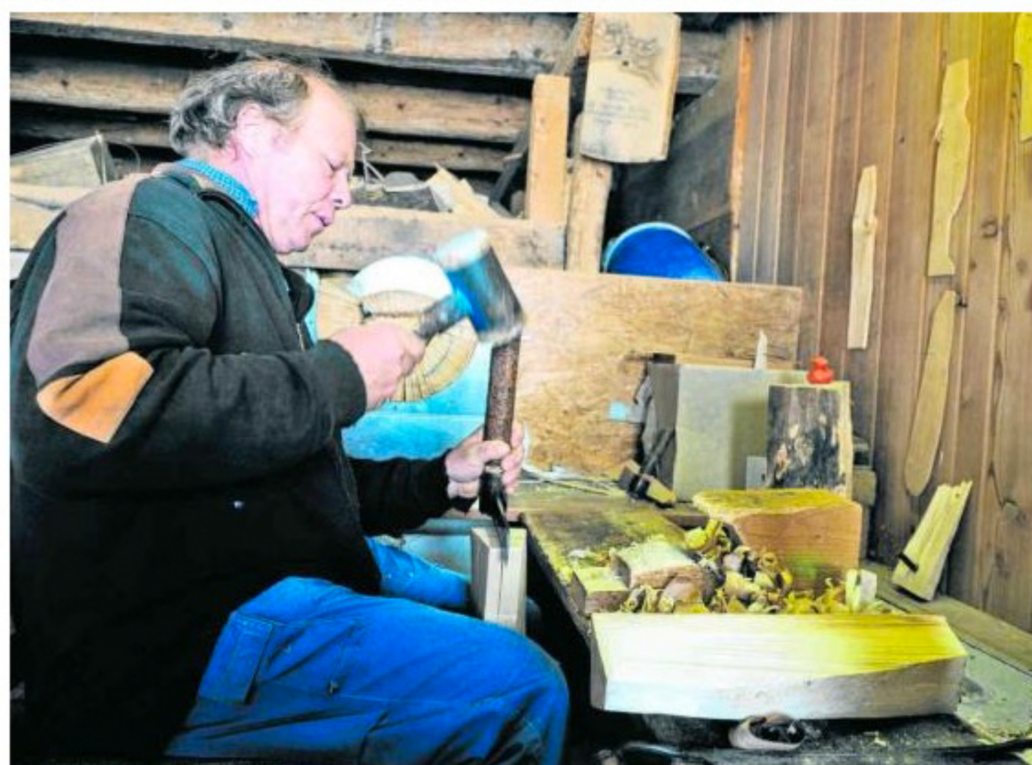
Fritz Künzle reisst die «Weggen» in seiner Werkstatt mit dem Schindeleisen auf. Bilder Aldo Ellena
